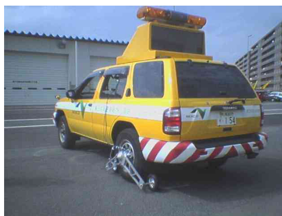
図 - 2 : IRI プロファイラ取り付け車両
